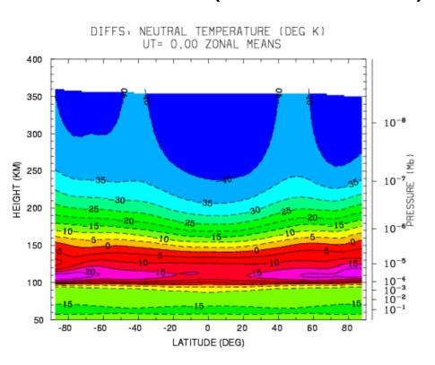
DIFFS: NEUTRAL TEMPERATURE (DEG K) UT= 0.00 ZONAL MEANS 350 300 HEIGHT (KM) 250 200 150  $10^{-5}$ 100 10<sup>-3</sup> 10<sup>-2</sup>  $10^{-1}$ 50 60 80 -60 LATITUDE (DEG)
